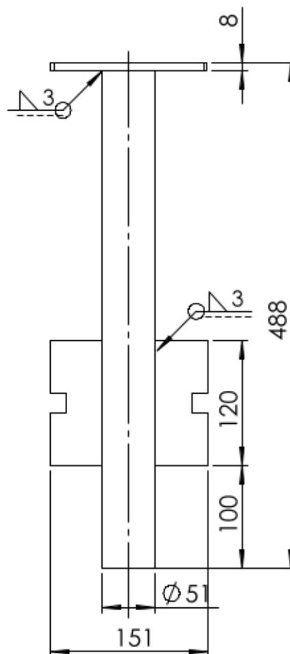
Feuerverzinkt nach EN1461 Schichtdicke  $\geq 70\mu\text{m}$
